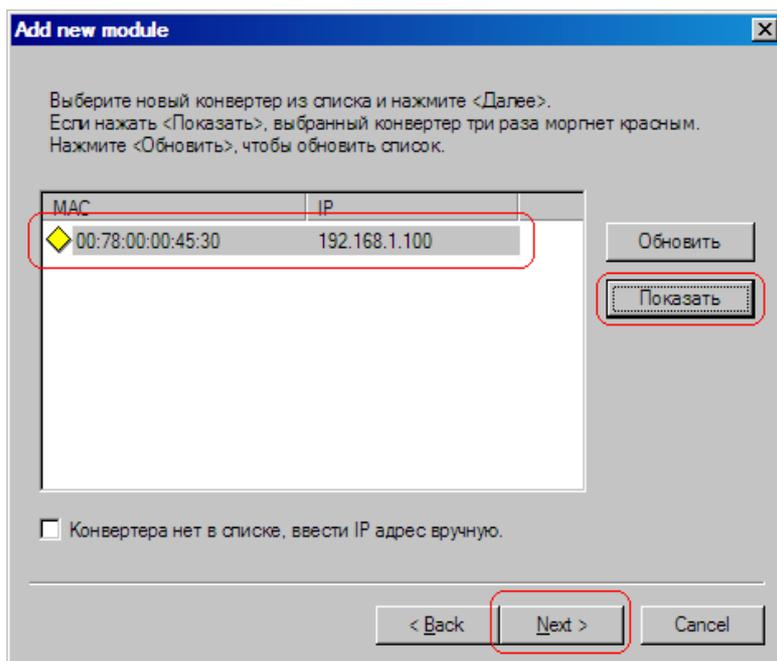
Следующий этап - установка IP адреса выбранного Ремультимплектора:
