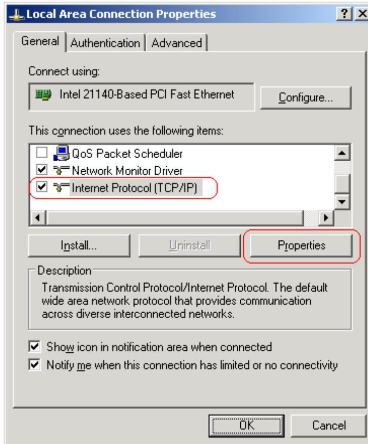
IP адрес компьютера может быть задан статически, или назначен динамически (DHCP). В этих примерах используется IP адрес компьютера **192.168.1.3**:
