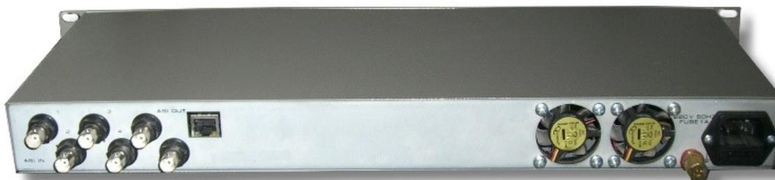
Управление Ремультимплексором осуществляется от ПК , который подключается по сети Ethernet к разьему RJ45 на задней панели. Этот же разъем используется и для IP выхода.
